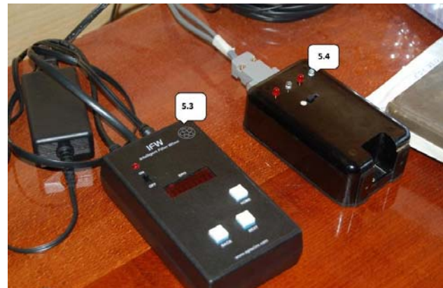
Рис.11 Блоки драйверов: 5.3— драйвер фильтра ; 5.4— драйвер поляроида.
